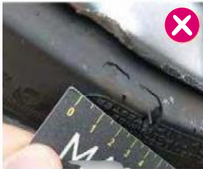
Pneu / Pneu usé / Déchirure À REMPLACER
