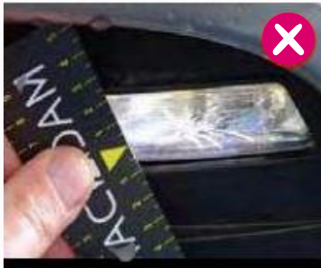
Éclat dans le faisceau d'éclairage À REMPLACER
